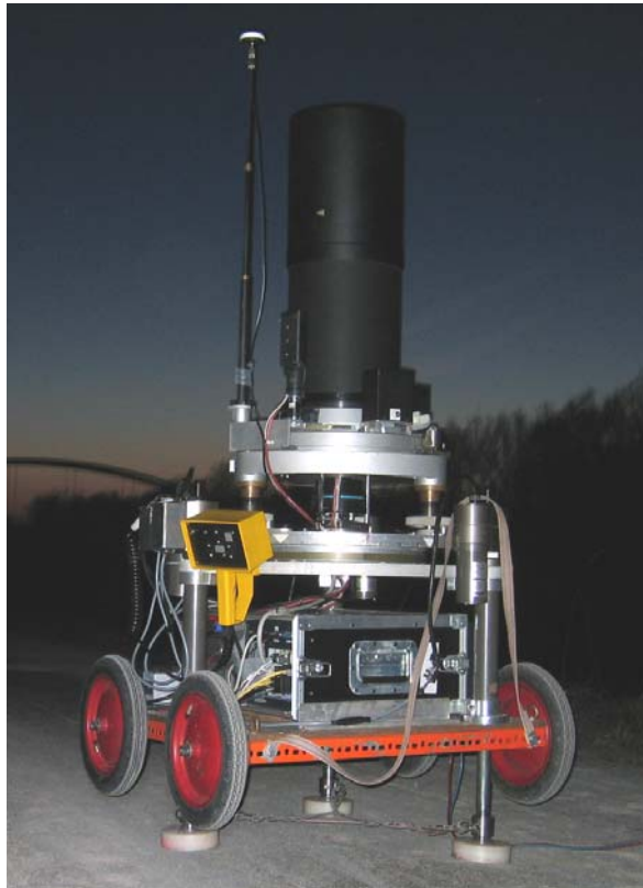
Abb. 4: Das digitale Zenitkameranystem TZK2-D (im Feldeinsatz 2005 am Mittellandkanal)
